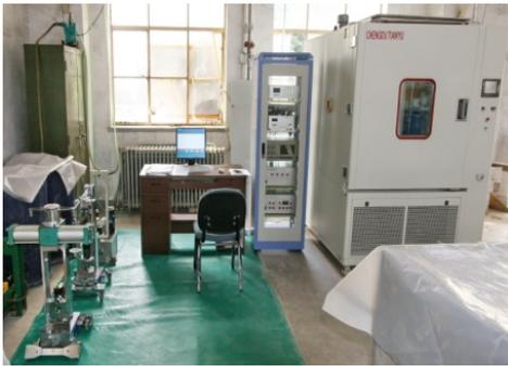
沥青混凝土冻断试验设备
